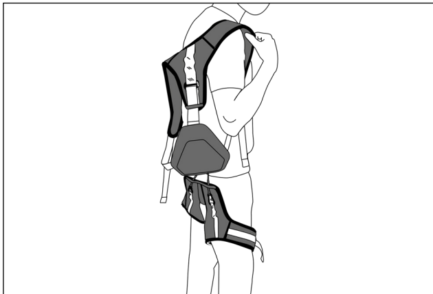
Figures 9a et 9b : Mise en place des bretelles (Étape 4)
